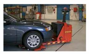
Сенсор на манипуляторе сканирует пространство вокруг, останавливает манипулятор в случае появления на его пути какого-либо препятствия и возобновляет движение сразу же после устранения препятствия. Для удобства устанавливается световая сигнализация имитирующая сканер радара. Достигнув
