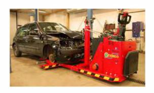
Передняя часть манипулятора имеет армированную панель и стальные прижимные ролики специально разработаны чтобы противостоять острым кромкам деталей автомобиля, которые имеют многие аварийные автомобили.
